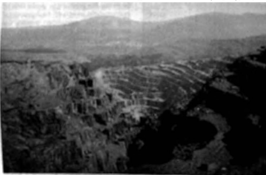
Kombinierter Tage- und Tiefbau mit 1,5 km langen Abbaufonten. Penrhyn Quarry, Bethesda
